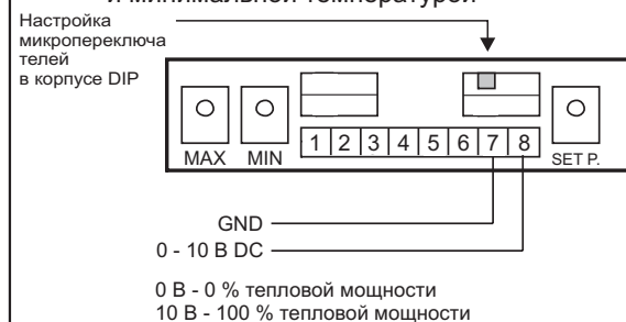
Рис. 5 Внешний датчик для наблюдения за максимальной и минимальной температурой
