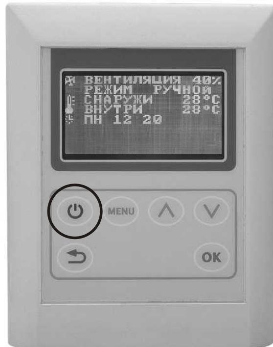
После включения системы с пульта дистанционного управления на мониторе компьютера изображаются следующие показания:
