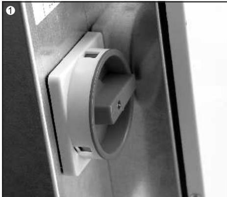
Система приводится в состояние выключения (Stand by) поворотом главного выключателя в положение I (включено).
