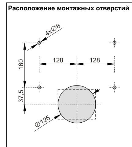
Установка прикрепляется к стене с помощью шурупов и шпонок.
