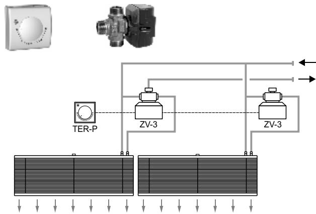
Пример регулирования тепловой мощности двух устройств смещиванием
