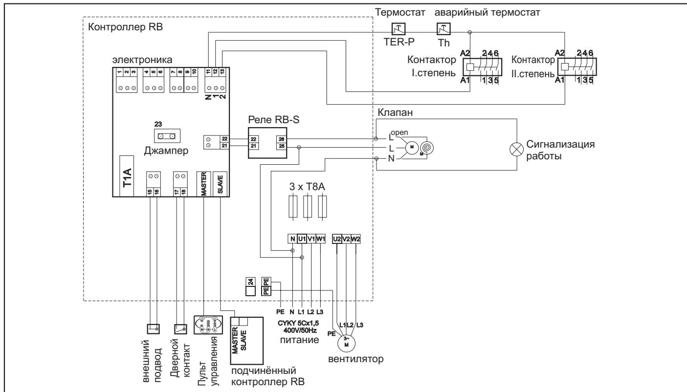
*Контроллер с однофазным вентилятором и водяным нагревателем*
