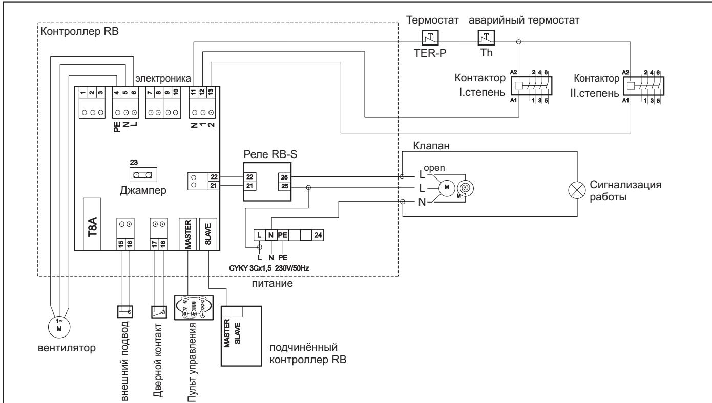
Контроллер с трехфазным вентилятором и электрическим нагревателем
