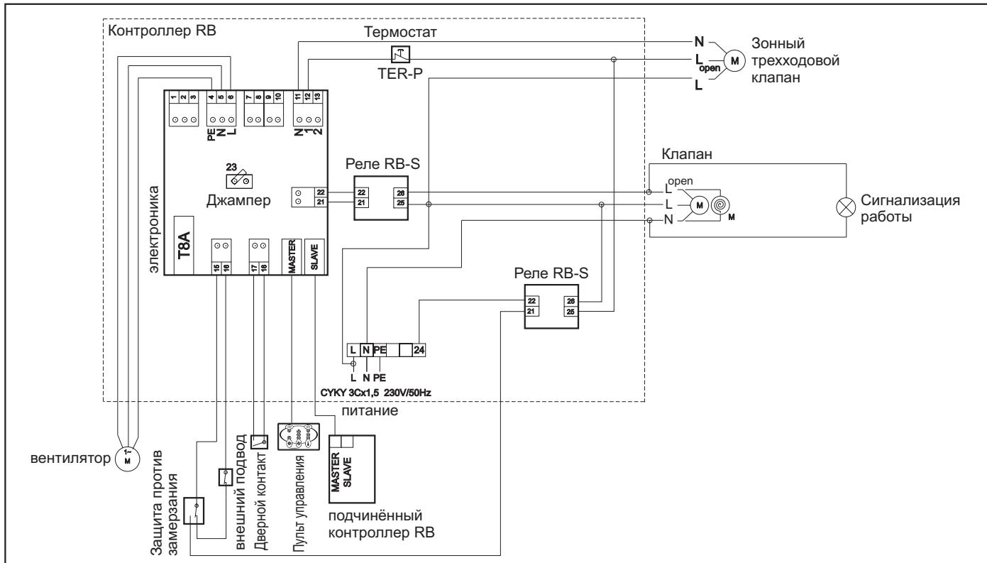
Контроллер с трехфазным вентилятором и водяным нагревателем
