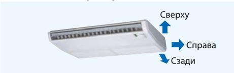
Трубопроводы для хладагента могут подключаться с трех сторон (сверху, сзади, справа), а дренажный трубопровод с двух сторон (слева и справа). Это значительно расширяет возможности монтажа. Сервисное обслуживание возможно только снизу.
