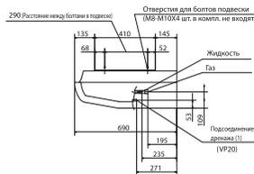
Примечание (1): Уклон дренажной трубы внутри блока составляет 10мм
