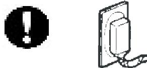
Загрязнение вилки сетевого провода или ее неправильное подсоединение к гнезду электропитания может стать причиной пожара или поражения электрическим током.
