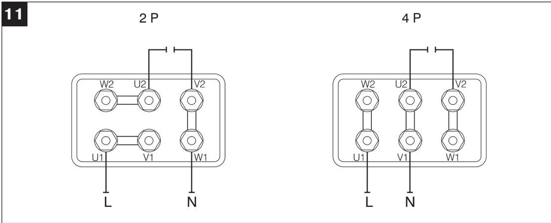
На (рис. 12) приведены электрические схемы подключения трехфазных двигателей
