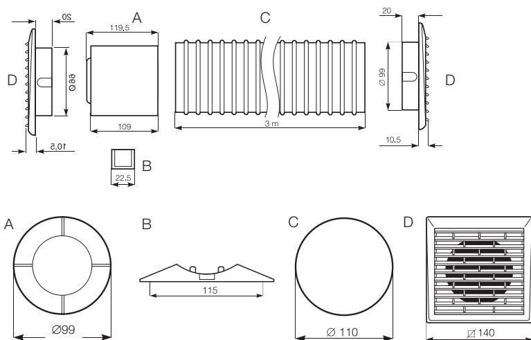
ЦЕНТРОБЕЖНЫЕ ВЫТЯЖНЫЕ ВЕНТИЛЯТОРЫ, БРЫЗГОЗАЩИЩЕННЫЕ, IPX4, ДЛЯ СКРЫТОЙ УСТАНОВКИ В ПОЛОЙ СТЕНЕ ИЛИ ПОДВЕСНОМ ПОТОЛКЕ ДЛЯ ПОДСОЕДИНЕНИЯ К ДЛИННЫМ ВОЗДУХОВОДАМ
