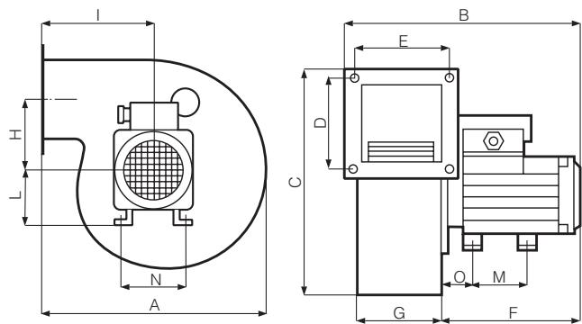
Агрегаты стандартного исполнения в спиральном корпусе LG. Ось нагнетательного отверстия расположена под углом 270° к вертикали.
