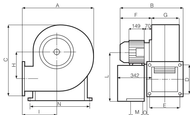
Агрегаты стандартного исполнения в спиральном корпусе LG. Ось нагнетательного отверстия расположена под углом 90° к вертикали.
