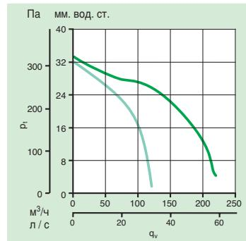
ДВУХСКОРОСТНЫЕ ЦЕНТРОБЕЖНЫЕ ВЫТЯЖНЫЕ ВЕНТИЛЯТОРЫ ДЛЯ НАСТЕННОГО И ПОТОЛОЧНОГО МОНТАЖА. БРЫЗГОЗАЩИЩЕННЫЙ КОРПУС, IPX4. ПОДСОЕДИНЕНИЕ К ВОЗДУХОВОДУ
