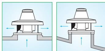
Простой монтаж на крышах всех типов. Пригоден только для удаления малозапыленного воздуха, не содержащего кислот и коррозионных агентов. Максимальная температура воздуха для режима непрерывной эксплуатации составляет 90 °C. Не предназначены для монтажа в трубах, расположенных непосредственно над открытыми каминаами или горелками.
