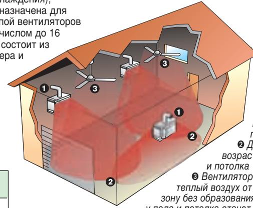
Торговое здание имеет систему воздушного отопления. С помощью регулируемых плоских лопастей, теплый воздух направляется вниз в обслуживаемую зону. Поскольку теплый воздух имеет меньший удельный вес, чем холодный, то он поднимается к потолку и скапливается там
