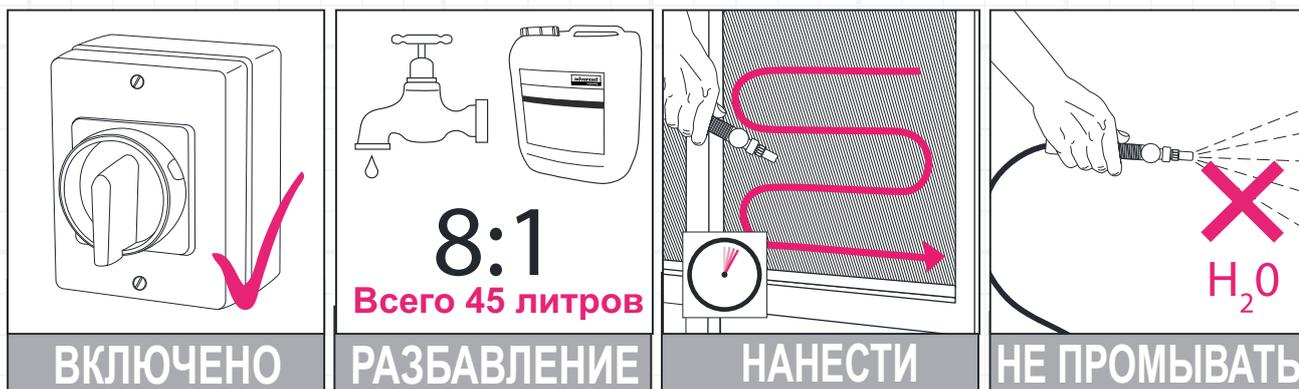
**Змеевики теплообменников** - промышленные системы и большие вентиляционные установки:
